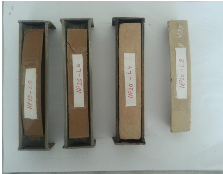
الشكل 27 صور لعينات التربة المعالجة في قوالب الانكماش بعد التجفيف في الفرن
